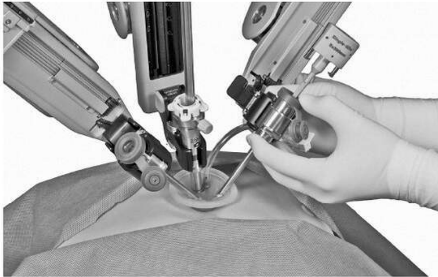
Мал. 5.9. «Docking» роботизованої системи
